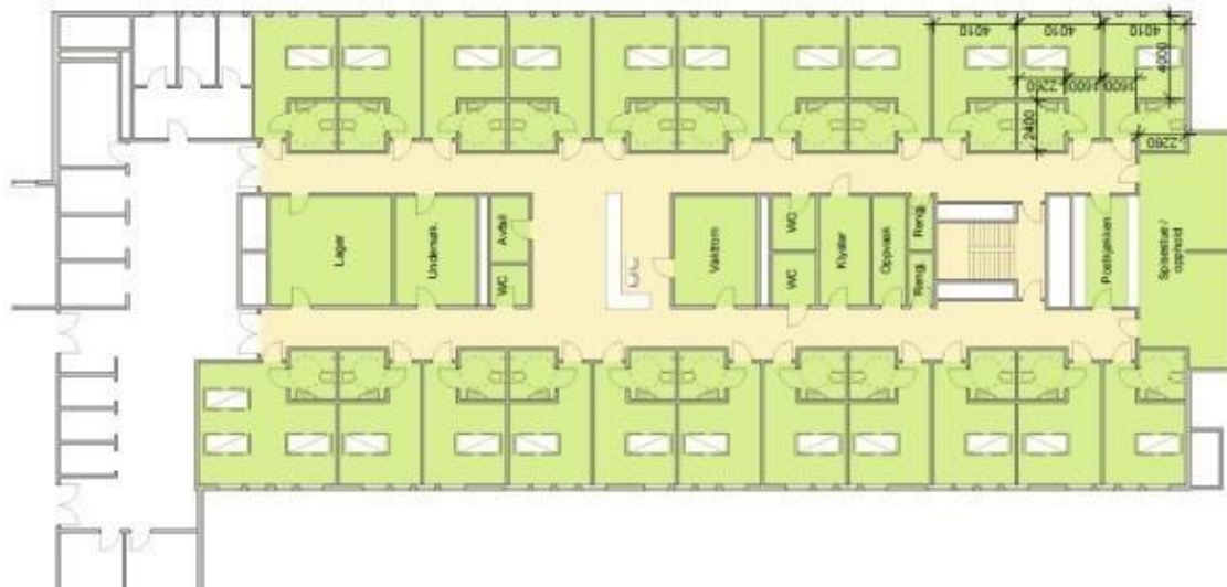
Figur: Prosjektet har tegnet ut enkelte funksjoner på romnivå for å vise at det er plass til løsningen som tenkt. Hentet fra idéfaserapporten.
