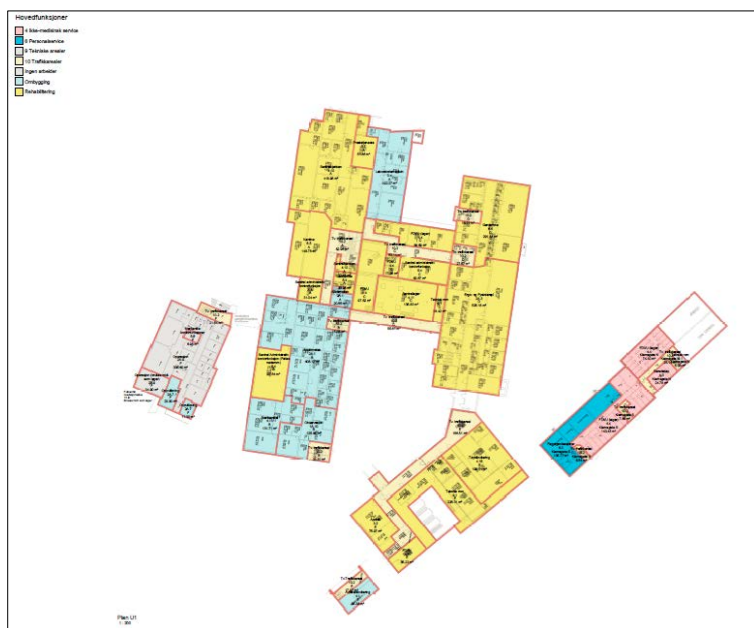
Figur 30: Eksempel, arealanalyse med presentasjon av ombyggingsarealer (funksjonell oppgradering) BLÅ arealer og rehabiliteringsarealer (teknisk oppgradering) GULE arealer.
