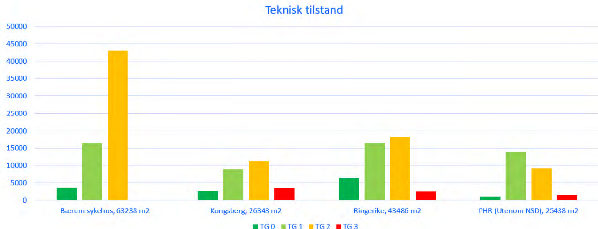
Figur 2: Teknisk tilstand per sykehus i 2024.
